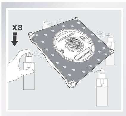
После распыления средства протрите нижнюю панель устройства WINBOT тканью для полировки.
