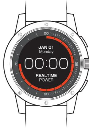
Часы «собирают» энергию в реальном времени - самостоятельно восполняют заряд батареи путем преобразования тепла вашего тела в электроэнергию. Штрихи и индикаторы заряда на циферблате прибавляются или убавляются, в зависимости от того, сколько тепла получают часы от вашего тела.
