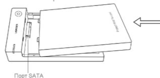
Шаг 3. Надавите снизу на переднюю панель, чтобы закрыть ее.
