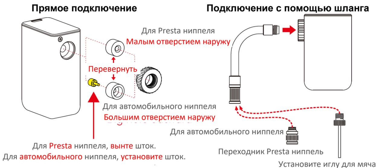
После извлечения насоса из упаковки, он сразу готов для накачки камеры с Presta ниппелем. Для накачки камеры с автомобильным ниппелем, пожалуйста установите соответствующий переходник. Шланг можно присоединить и использовать напрямую, независимо от наличия штока. Если целевое давление превышает 100 PSI, для предотвращения утечки воздуха через ниппель, пожалуйста, используйте шланг.
