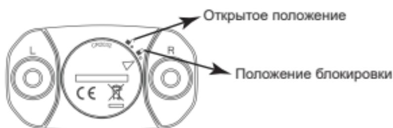
1. С помощью монеты поверните стрелочный указатель на крышке отсека батареи против часовой стрелки из положения блокировки в открытое положение, чтобы открыть отсек для батареи
